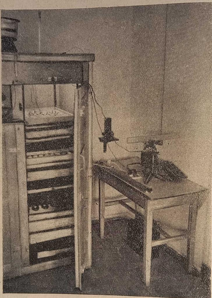
Рис. 18. Апаратура для вимірювання внутріяйцевої температури.
